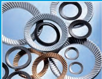
Le Rondelle di Sicurezza Originali SCHNORR® sono a sezione trapezoidale dentate da entrambe le parti, i diametri sono adattati alla dimensioni delle viti. Il diametro esterno della rondella coincide con il diametro esterno della testa delle viti a testa cilindrica e ad esagono cavo.
